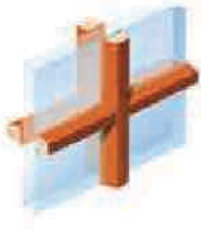
Kleinhouten geplaat op het glas, 26 mm met duplex
